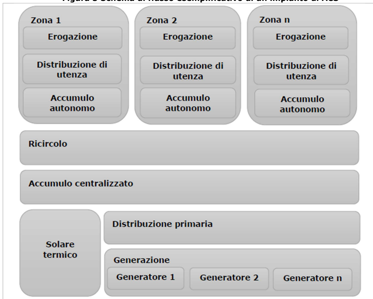
Figura 3 Schema di flusso esemplificativo di un impianto di ACS
